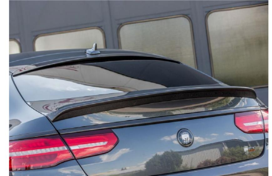
Dachblende, Heckspoilerlippe und Heckzierleiste in Sichtcarbon
