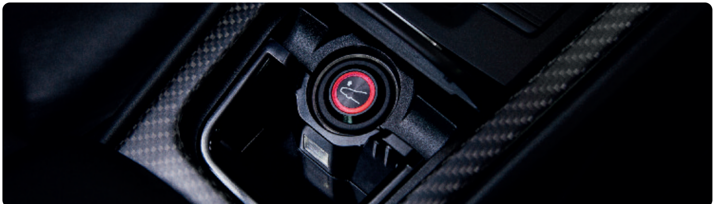
Perfekte Integration: TECHART Noselift Bedienschalte im Ablagefach der Mittelkonsole. Perfect integration: TECHART Noselift button in the center console storage compartment.
